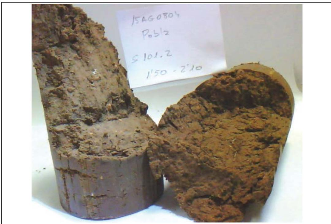
Detalle del plano de rotura
