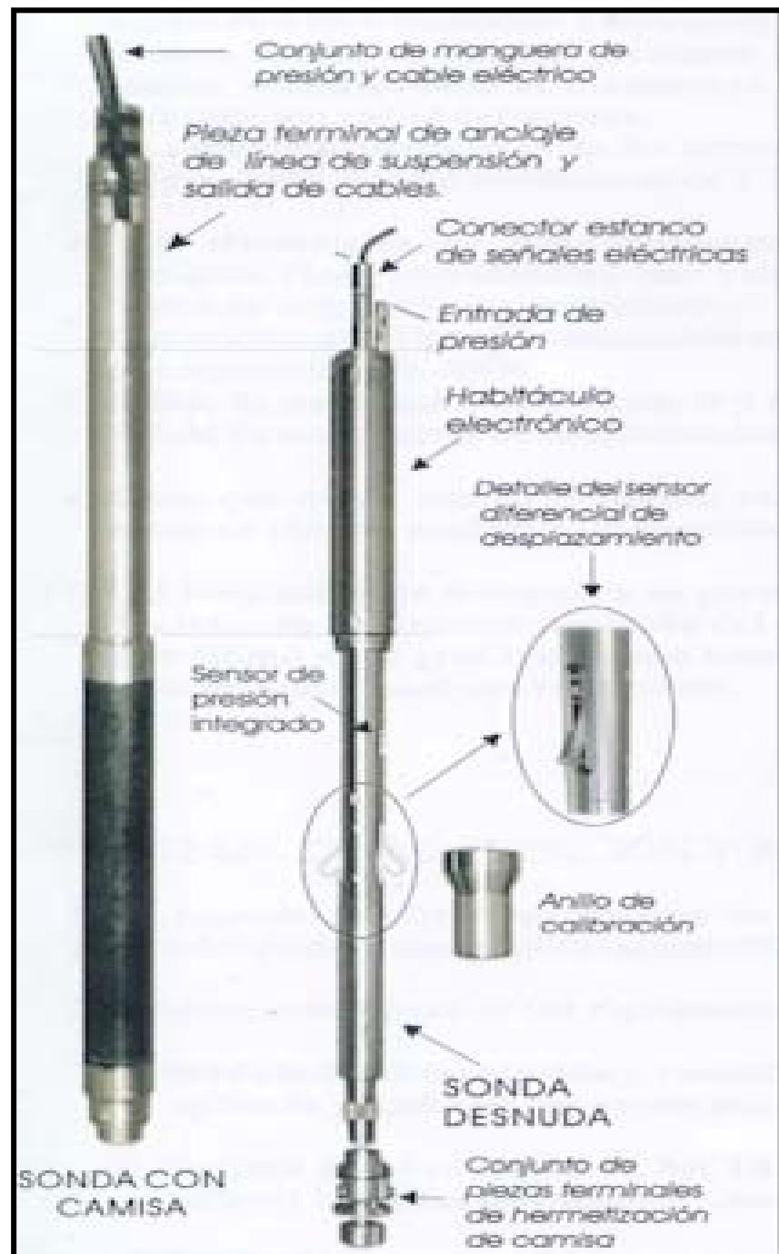
DETALLE DEL PRESIÓMETRO ELASTMETER 200. OYO
