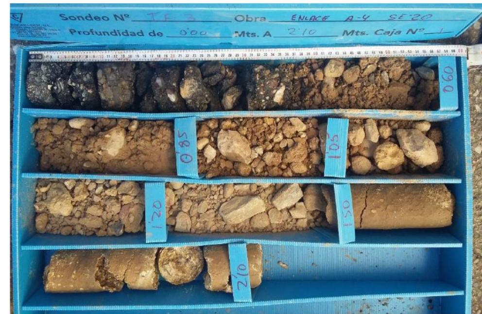
Foto Testigos TF-3. Detalle del material extraído con equipo de sondeos y corona de diamante.
