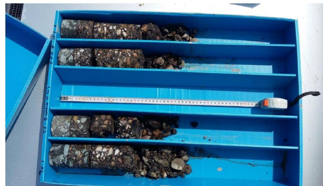
Foto Testigos TF-1, TF-2 y TF-5. Detalle del material extraído con saca-testigos Hilty.
