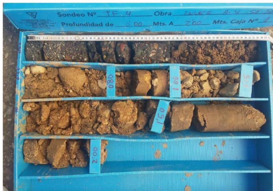
Foto Testigos TF-4. Detalle del material extraído con equipo de sondeos y corona de diamante.
