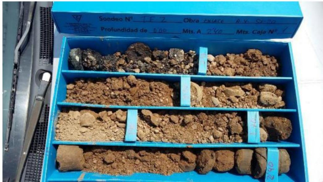
Foto Testigo TF-2. Detalle del material extraído con equipo de sondeos
