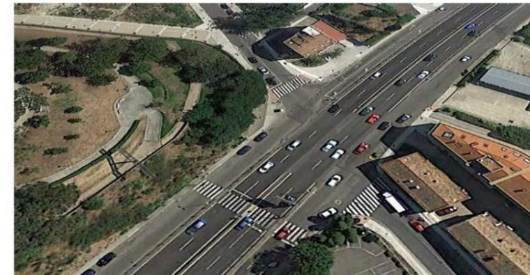
A partir del P.K. anterior, en determinados tramos limitados por las incorporaciones y salidas del viario municipal, las vías de servicio pasan a tener dos carriles y sección reducida de seis (6) metros.
