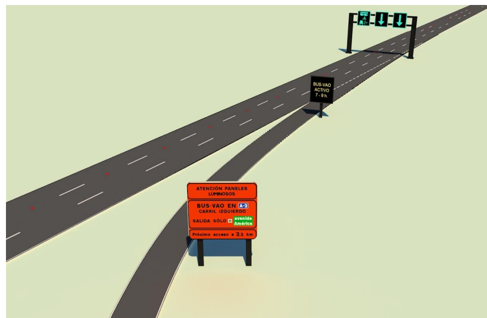
Señalización variable en los accesos al tronco
