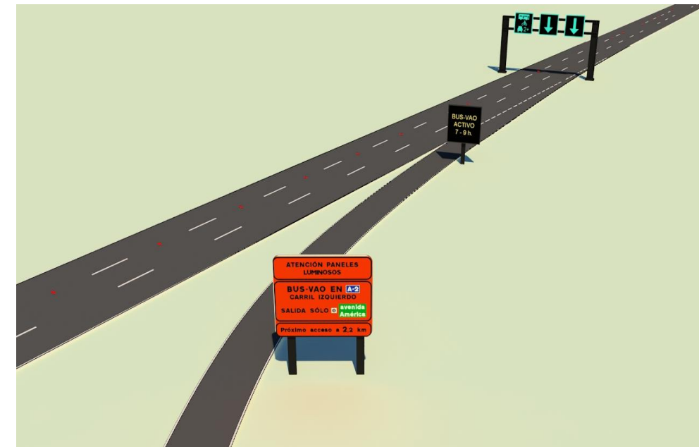
Señalización variable en los accesos al tronco
