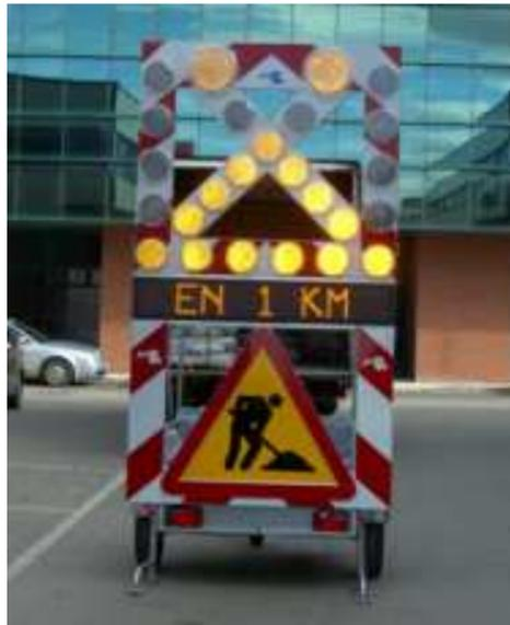
Remolque con Conjunto de 25 focos halógenos (flecha izquierda, derecha y aspa) 2 focos Xénon-Flash y PMV 10 caracteres
