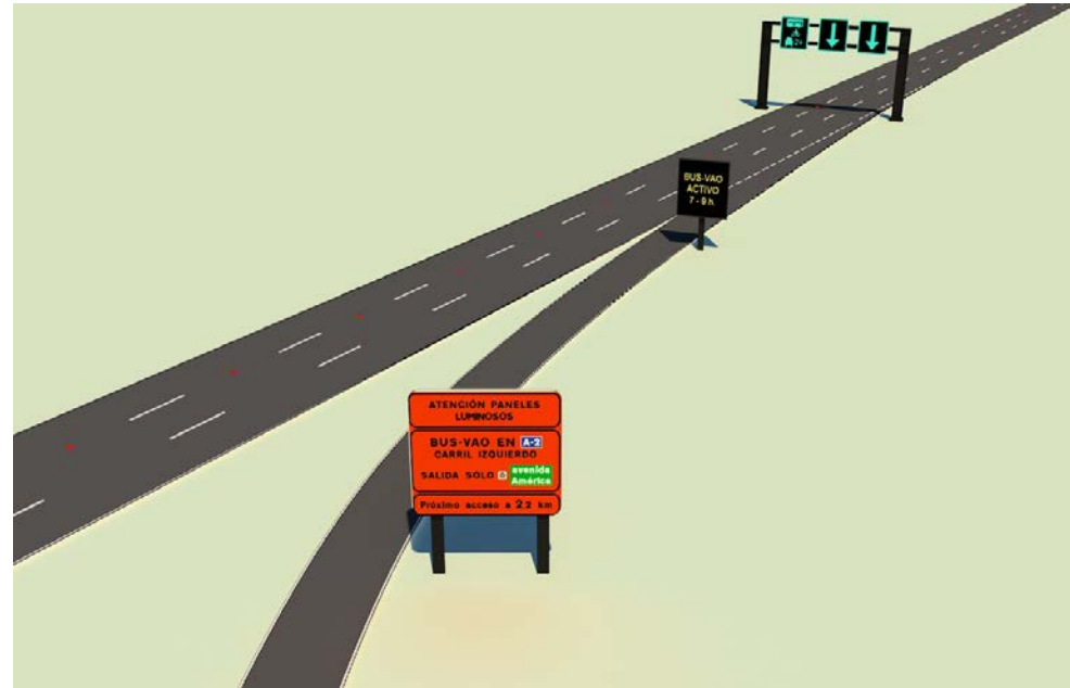
Señalización variable en los accesos al tronco
