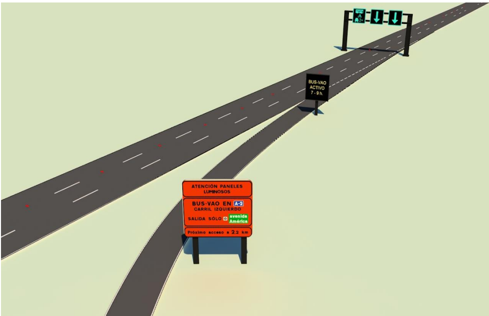
Señalización variable en los accesos al tronco
