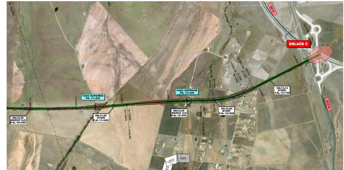
A partir del p.k. 10+500 y hasta la conexión con la A-66 coinciden las 4 primeras alternativas del primer tramo del estudio (conexión de la A-58 con la A-66). La autovía toma dirección oeste por el borde del mencionado refugio de fauna hasta el p.k 13+000 que gira a la izquierda para conectar con A-66 en el enlace entre la A-66 y la N-630.
