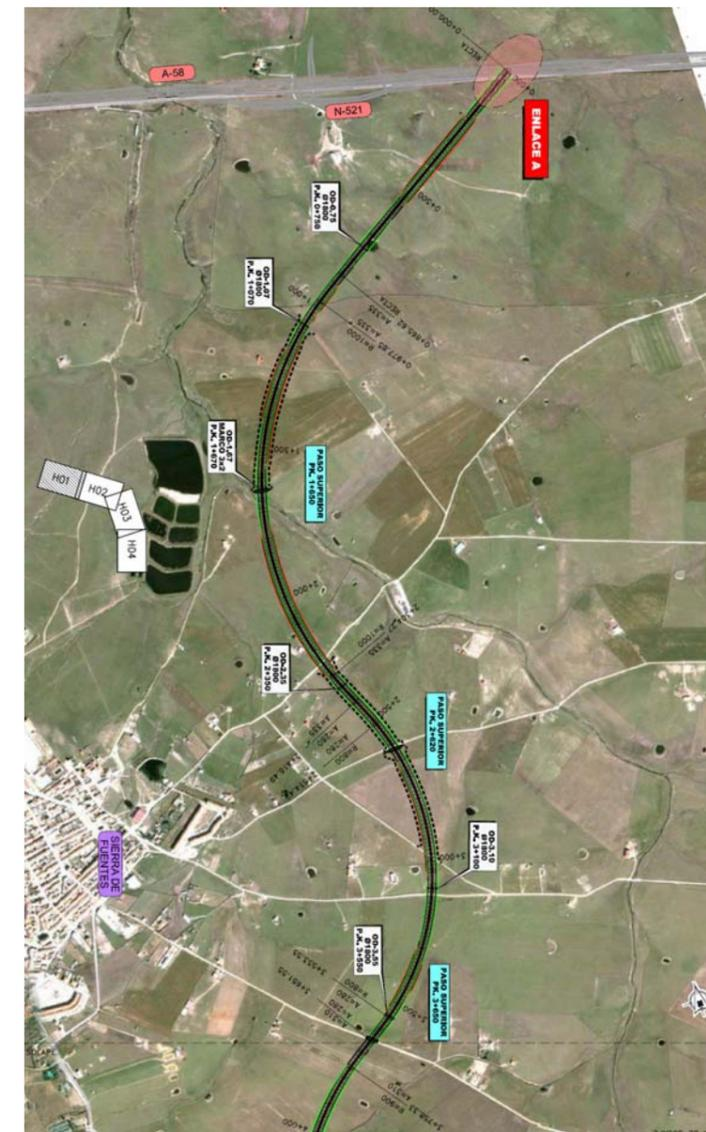
Entre los kilómetros 4 y 6 la nueva autovía circula con dirección sur paralela a la carretera que conecta Sierra de Fuentes con la EX-206. En el p.k. 6+600 interseca con la EX-206 y se proyecta un enlace.
