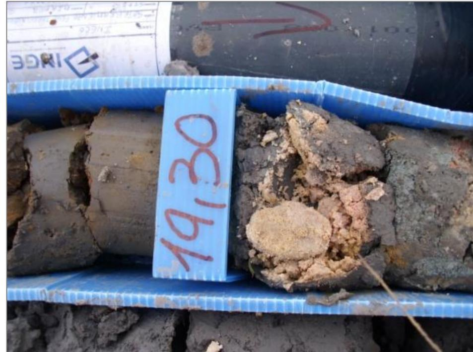
Detalles materiales formación  $Q_{M2}$  a 19,30 m de profundidad, se observa un canto de arenisca.
