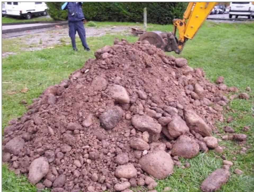
*Materiales aluviales fundamentalmente gravosos con algo-bastante bolos sub-redondeados heterométricos.*
