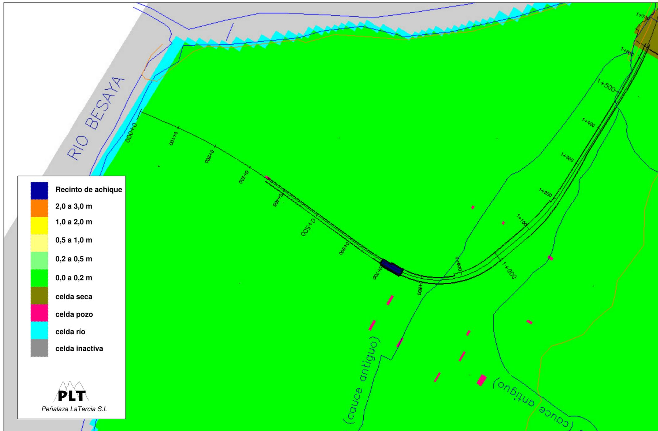
Fig. 18 Plano de isodescensos en la simulación N° 11 en régimen permanente
