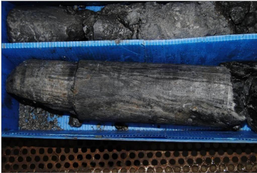
Detalle de estos materiales, se observa claramente la alternancia de niveles yesíferos y las lutitas negras. La estratificación es subvertical.
