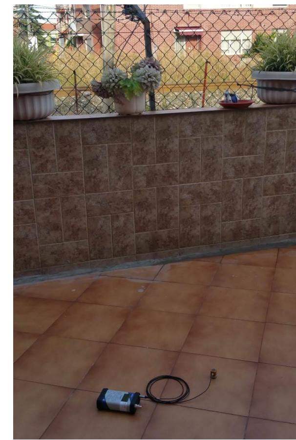
Acelerómetro triaxial a 10,5 m del eje
