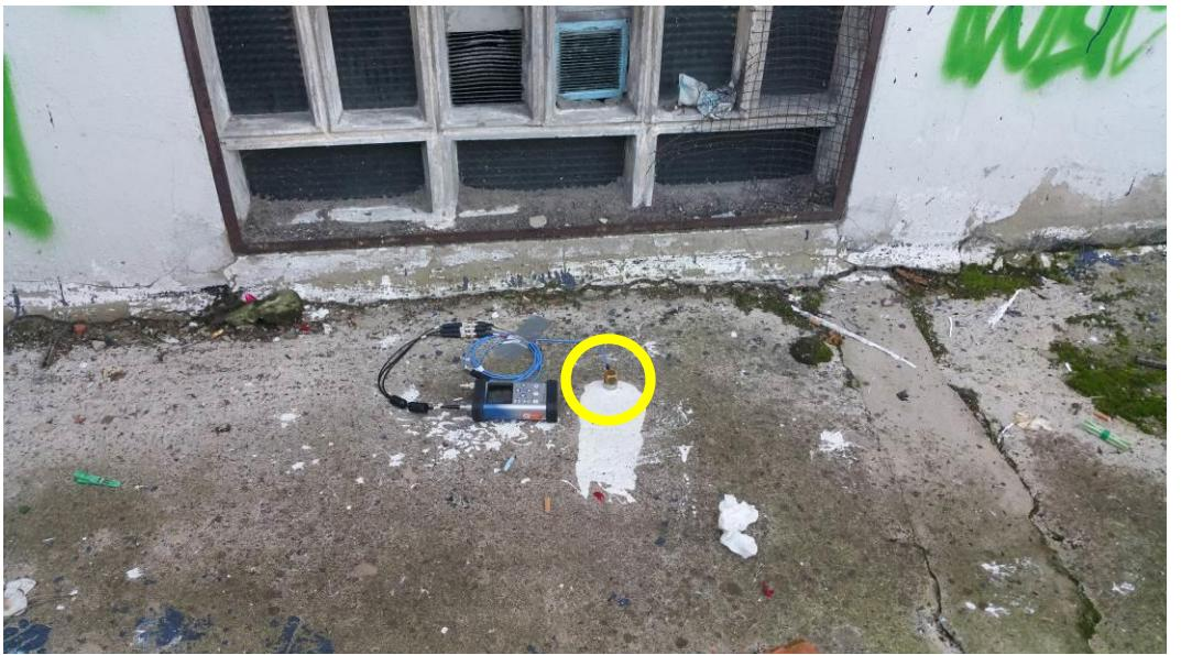
Detalle del acelerómetro triaxial a 16,5 m del eje (dentro del círculo amarillo)
