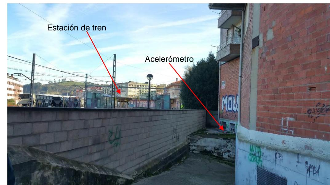
*Acelerómetro triaxial a 16,5 m del eje de la vía más cercano y a 20 m del eje de la vía más lejana*
