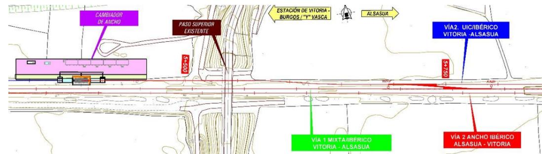
ILUSTRACIÓN 30 CAMBIADOR DE ANCHO EN CONEXIÓN CON LA LÍNEA MADRID-HENDAYA.
