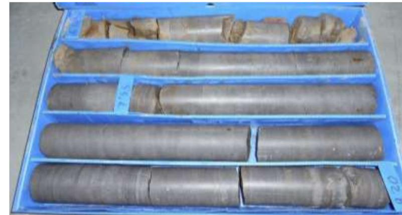
Fotografía 1 Aspecto de la unidad Mg en el sondeo S-1 (Fuente: Estudio Geotécnico previo para la Inserción de la Alta Velocidad en Vitoria – Gasteiz, 2017)
