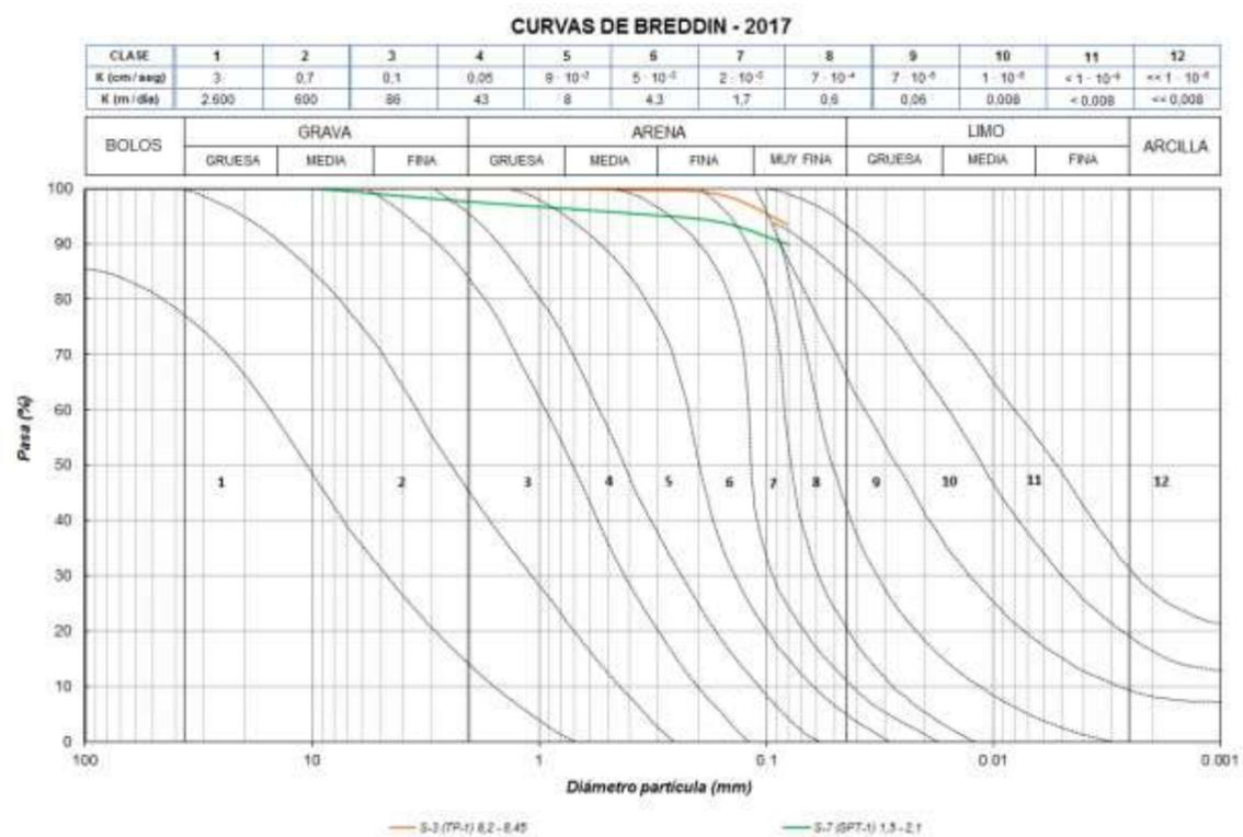
Figura 23. Superposición de las curvas granulométricas del eluvial, obtenidas a partir de ensayos granulométricos por tamizado en la campaña de 217, sobre Ábaco de Breddin (elaboración propia).
