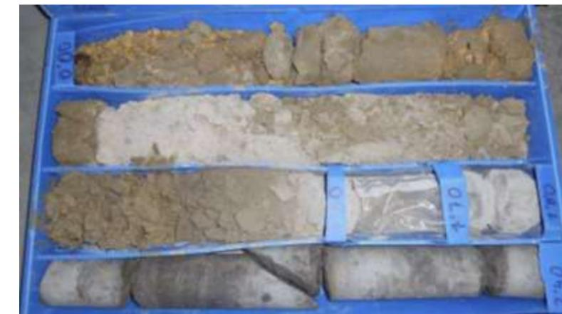
Fotografía 2 Aspecto de la superficie alterada en el sondeo S-4 (Fuente: Estudio Geotécnico previo para la Inserción de la Alta Velocidad en Vitoria – Gasteiz, 2017)
