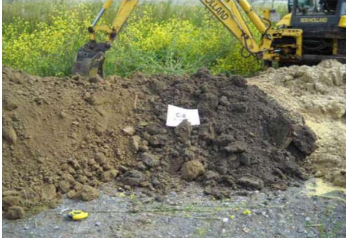
Fotografía 3 Aspecto de dos niveles de aluvial, Sal, en la cata C-8, a la altura del 6+250 del Tramo T02 (Fuente: Proyecto Básico de Plataforma para la Integración del ferrocarril en la ciudad de Vitoria/Gasteiz. Fase I, 2012)
